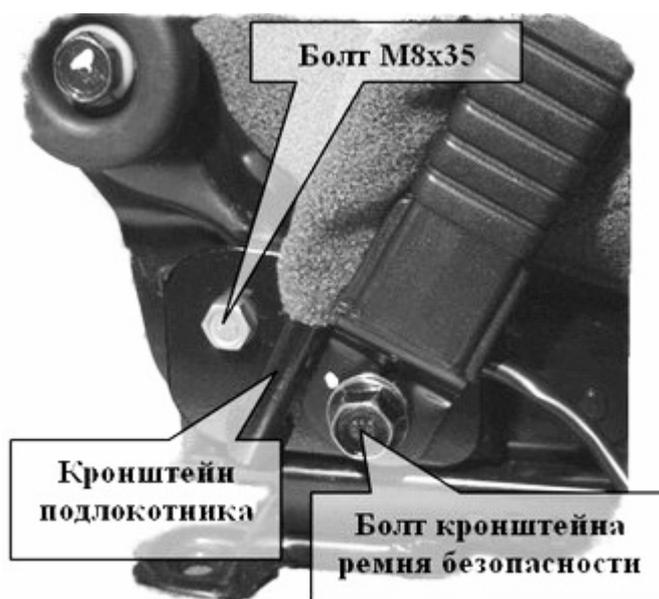
1. Сдвинуть сиденье водителя назад, и находясь со стороны заднего сиденья, ключом на 13 вывернуть болт М8. Вывернуть болт крепления замка ремня безопасности. Установить подлокотник, совместив отверстия кронштейна с отверстиями каркаса. Установить замок ремня безопасности, используя штатный болт, в место штатного болта М8 установить прилагаемый болт М8х35. Обтянуть болты.
