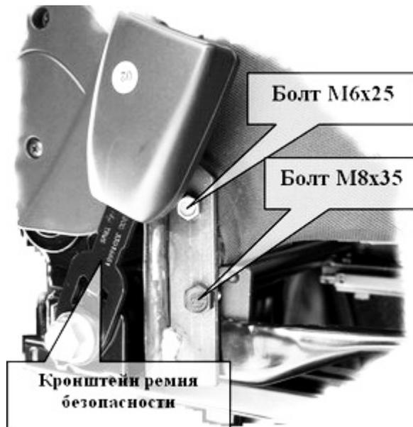
**Подлокотник передний (средний) устанавливается на сиденье водителя на две существующие точки крепления. В процессе установки требуется заменить штатный болт М6х10 на болт М6х20. Используются ключи на 10 и 17**
