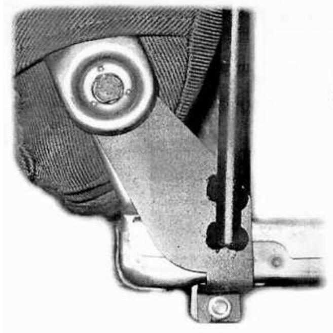
Подлокотник передний (средний) устанавливается на сиденье водителя, на две существующие точки крепления. В процессе установки требуется заменить штатный болт на болт M8x30.
