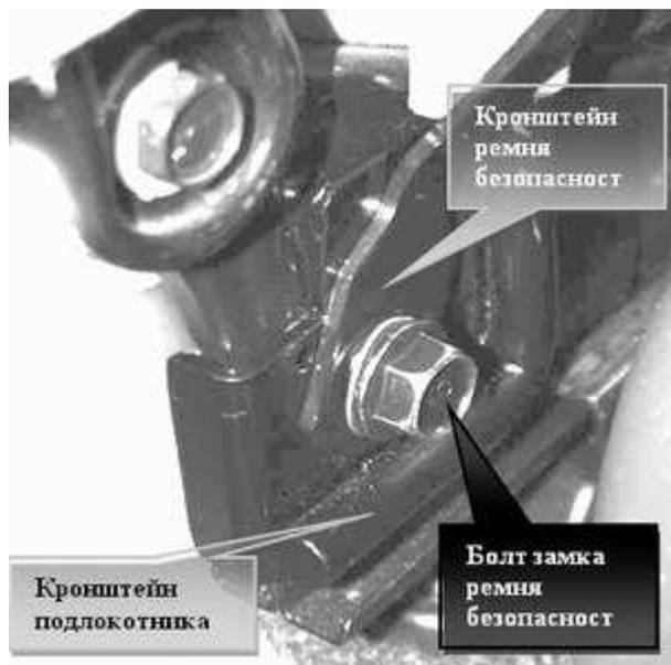
**Подлокотник передний (средний) устанавливается на сиденье водителя на две существующие точки крепления. В процессе установки требуется заменить штатный болт М6х10 на болт М6х20. Используются ключи на 10 и 17**
